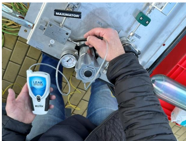
Obr. 2 Test těsnosti odběrového panelu
