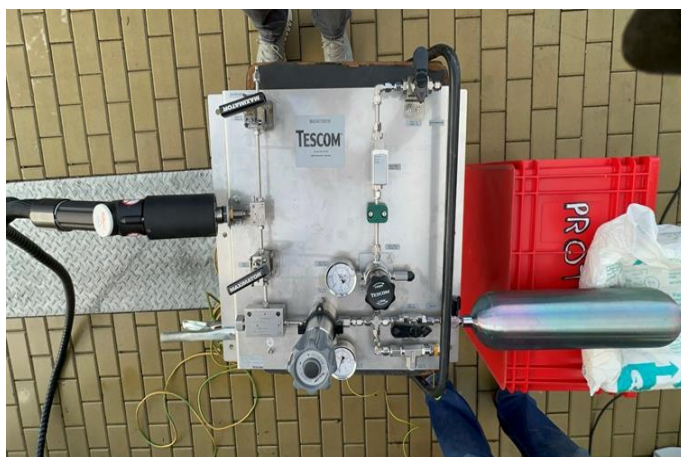
Obr. 3 Systém plnění vodíku do vzorkovnice
